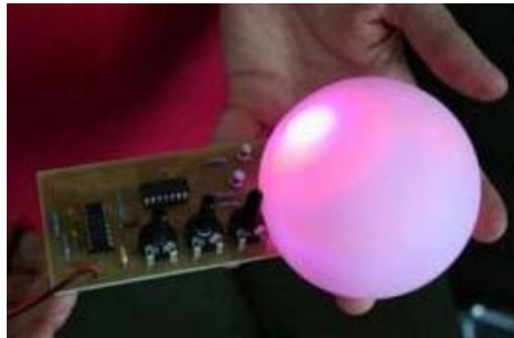
Farbwahl mit Leuchtdioden-RGB-Dimmer (© dEIn Labor)
